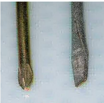
Pontas de chave de fenda mostrando Philips (esquerda) e planas ou com fenda (direita)
