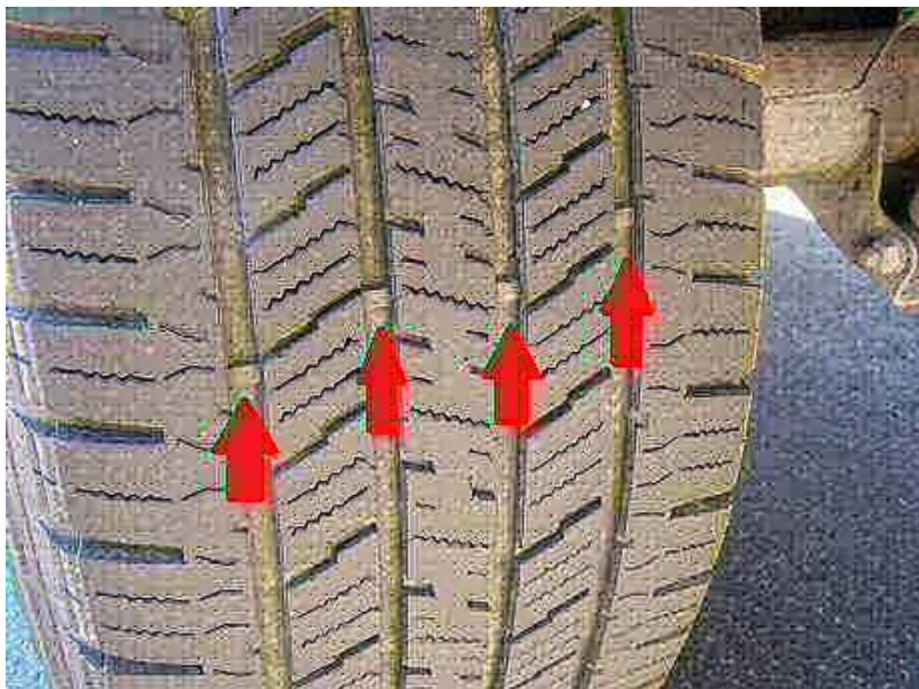
Pneu com setas apontando para as barras de desgaste entre as bandas de rodagem.
