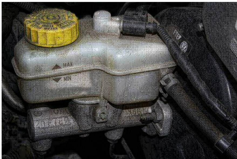
Um reservatório de fluido de freio. Observe as marcações MAX e MIN. Crédito da imagem: CC-BY-Frettie na Wikipedia
