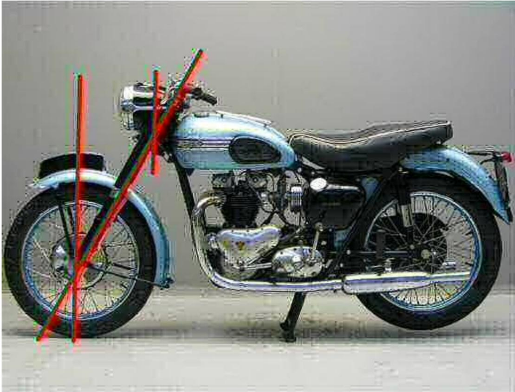
Um rodízio positivo é facilmente visto nas rodas dianteiras de motocicletas e bicicletas. Imagem adaptada, crédito original: CC-BY-SA-Yesterdays Antique Motorcycles na Wikipedia
