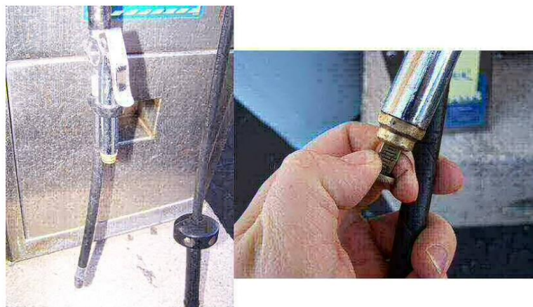
Mangueira de distribuição de ar em um posto de gasolina com manômetro embutido
