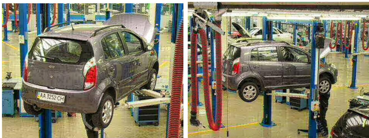
Elevador hidráulico com braços de elevação que elevam o veículo nos seus pontos de elevação. O elevador consiste em duas vigas verticais azuis e quatro braços de elevação brancos. Dois braços de elevação brancos do outro lado do veículo não são vistos nas fotos.
