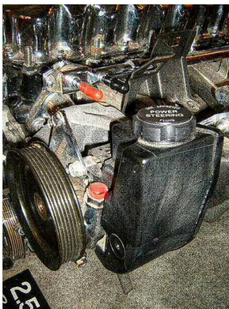
Reservatório de direção hidráulica (tanque preto). Observe como a tampa está rotulada.
