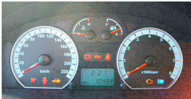
Painel mostrando medidores e luzes indicadoras de advertência Crédito da imagem: CC-BY-SA-Tagaz Vega
