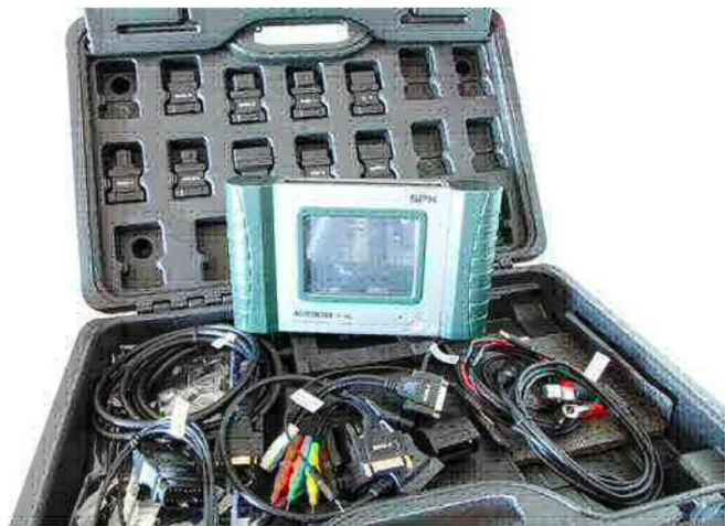
Auto scanner que recebe DTCs do computador do veículo Crédito da imagem: CC-BY-SA-Florian Schaffer
