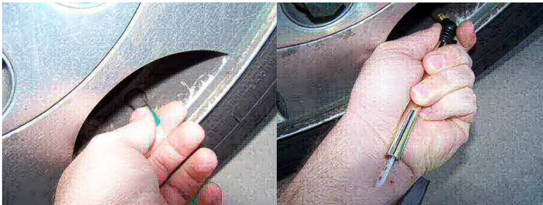
Verificando a pressão dos pneus
