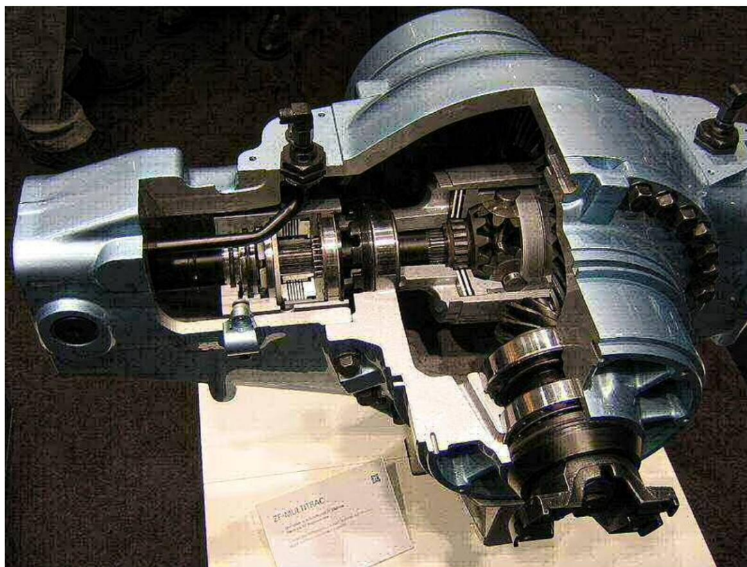
Um diferencial para um veículo alemão com recorte para ver o interior.
