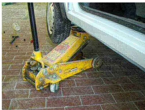
Macaco hidráulico com mecanismo de bomba manual
